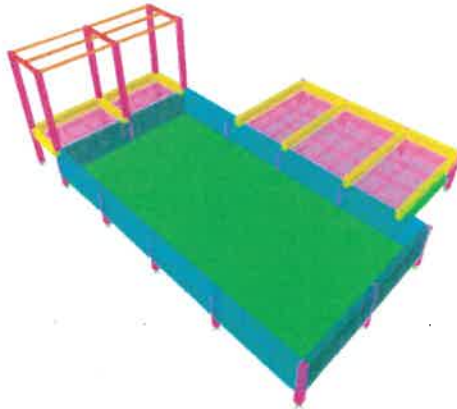
รูป 4: แบบจำลอง 3 มิติเพื่อการวิเคราะห์และออกแบบโครงสร้าง อาคารสระว่ายน้ำ
