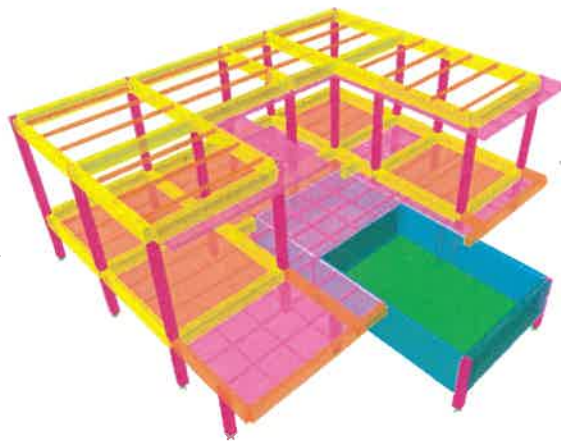
รูป 5: แบบจำลอง 3 มิติเพื่อการวิเคราะห์และออกแบบโครงสร้าง อาคารบ้าน POOL VILLA 1
